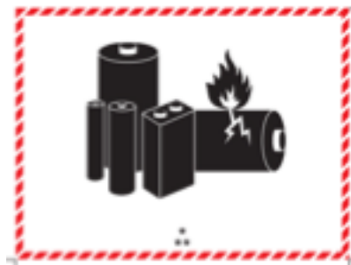
Figura 14 - Etichetta d'imballaggio ADR 2017 per le batterie al litio
