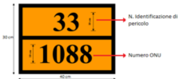
Figura 2 – Pannello arancione di pericolo per i veicoli secondo ADR
